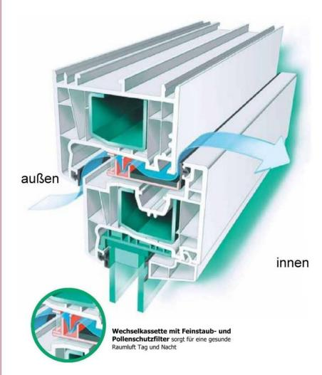
Frischluftzufuhr über die oberen Fensterrahmen
